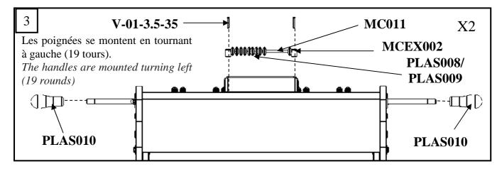
Les barres doivent être <u>impérativement entretenues régulièrement</u> avec un lubrifiant spécifique. Ce produit est en vente chez René Pierre S.A. Vous trouverez le bon de commande dans le carton. Rods must be <u>regularly maintained</u> with silicon spray. This product is selling at René Pierre SA. The order form is in the box.
